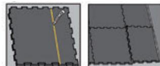
Bei Bedarf Randmatten zurecht schneiden und einpassen
