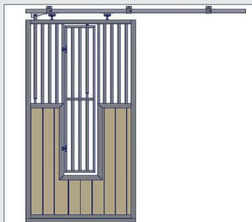
In die Schiebetür bauen wir eine verschließbare Klappe, die als Fressplatz geöffnet werden kann. Lichte Weite der Fressplatzöffnung ca. 300 mm B x 1700 mm H.
