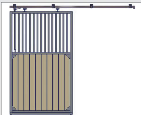
Schiebetür für Pferdebox zum Anschrauben/Dübeln an vorhandene Mauern oder Boxenwände. Schiebetür 1300 mm breit x Türrahmen 2150 mm H inkl. C-Profilsschiene (3000 mm lang) 2 Laufwagen, Stopper und Schienenhalter.
