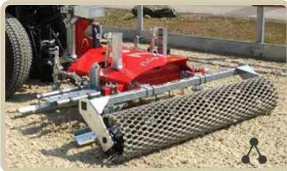
**Ausstattung:** 3-Punkt-Aufnahme, Nachlaufeinrichtung, 2 Reihen Federstahlzinken, Gitternetzwalze, höhenverstellbares Fahrwerk
