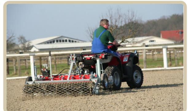
**Ausstattung:** Kugelkopfkupplung, hydraulisches Fahrgestell, Hufschlagräumer groß, Bandenrolle groß ausziehbar, Gitternetzwalze Ø 345 mm
